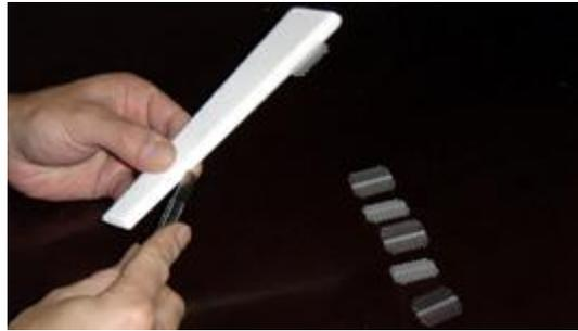
**Kleben Sie die 3mm Kohlefaser-Verstärkungen und den Holm aus Holz für den Motorträger in die Aussparungen in der Tragfläche ein.**
