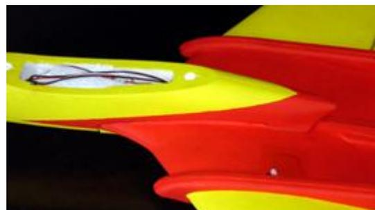
**Zur Kabinenhauben-Befestigung kleben Sie in die Führungen der Haube mittig je einen kurzen, leicht angespitzten 2mm Kohlefaser- oder Holzstab ein.**
