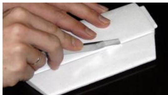
**Schneiden Sie Schlitz für die Scharniere in die Querruder und das Höhenruder, stecken diese ohne Klebstoff hinein und schneiden dann entsprechende Schlitz in die Tragfläche und das Höhenleitwerk.**
