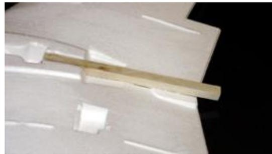
**Bringen Sie an den Enden der Kabelkanäle die Durchführungen für die Servokabel zum Rumpf und für das Höhenruder-Servo durch die Tragfläche ein.**
