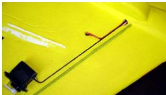
**Bereiten Sie jetzt die einzubauenden Servos mit Hilfe ihrer Fernsteuerung so vor, dass die Ruderhörner in Neutralstellung montiert sind und kleben Sie anschließend die Servos in die vorgesehenen Aussparungen in der Tragfläche. Empfehlenswert ist hierzu die Benutzung von Servotape (doppelseitiges Klebeband).**
