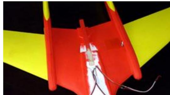
**Verbinden Sie nun die Querruder mit der Tragfläche und das Höhenruder mit dem Höhenleitwerk durch Einkleben der Scharniere.**
