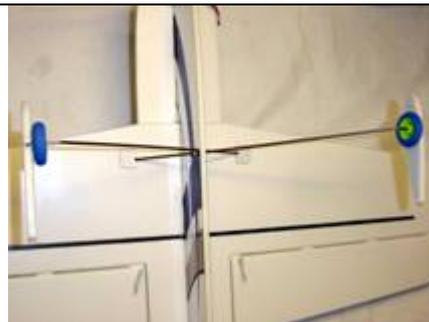
Winkeln Sie die beiliegenden Fahrwerksdrähte im Bereich der Radaufnahme ab, stechen sie über Kreuz durch den Rumpf und leicht in die Tragfläche ein.
