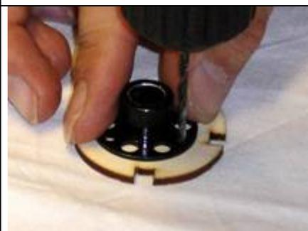
Montieren Sie den Motor an den Motorträger.
