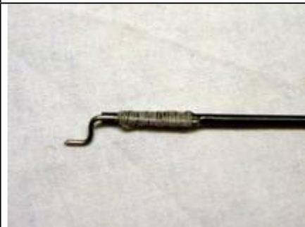
Biegen Sie aus dem beiliegenden dünnen Stahldraht die Ruderanlenkungen und kürzen diese auf ca. 2cm.
