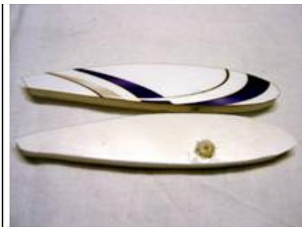
Für die Montage der Radschuhe empfiehlt es sich, ein kurzes Stück Silikonschlauch mit passendem Innendurchmesser einzukleben.
