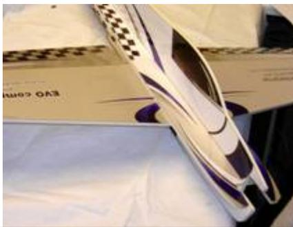
Passen Sie Rumpfseitenteile so an den Rumpf an, dass die Motor-Aussparungen bündig zu der Motorausparung am Rumpf sind.
