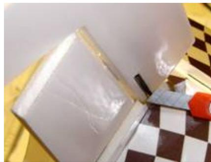
Prüfen Sie die Länge der Seitenteile im Bereich des Höhenruder-Scharniers und kürzen sie etwas, falls sie das Höhenruder in seiner Bewegungsfreiheit behindern.
